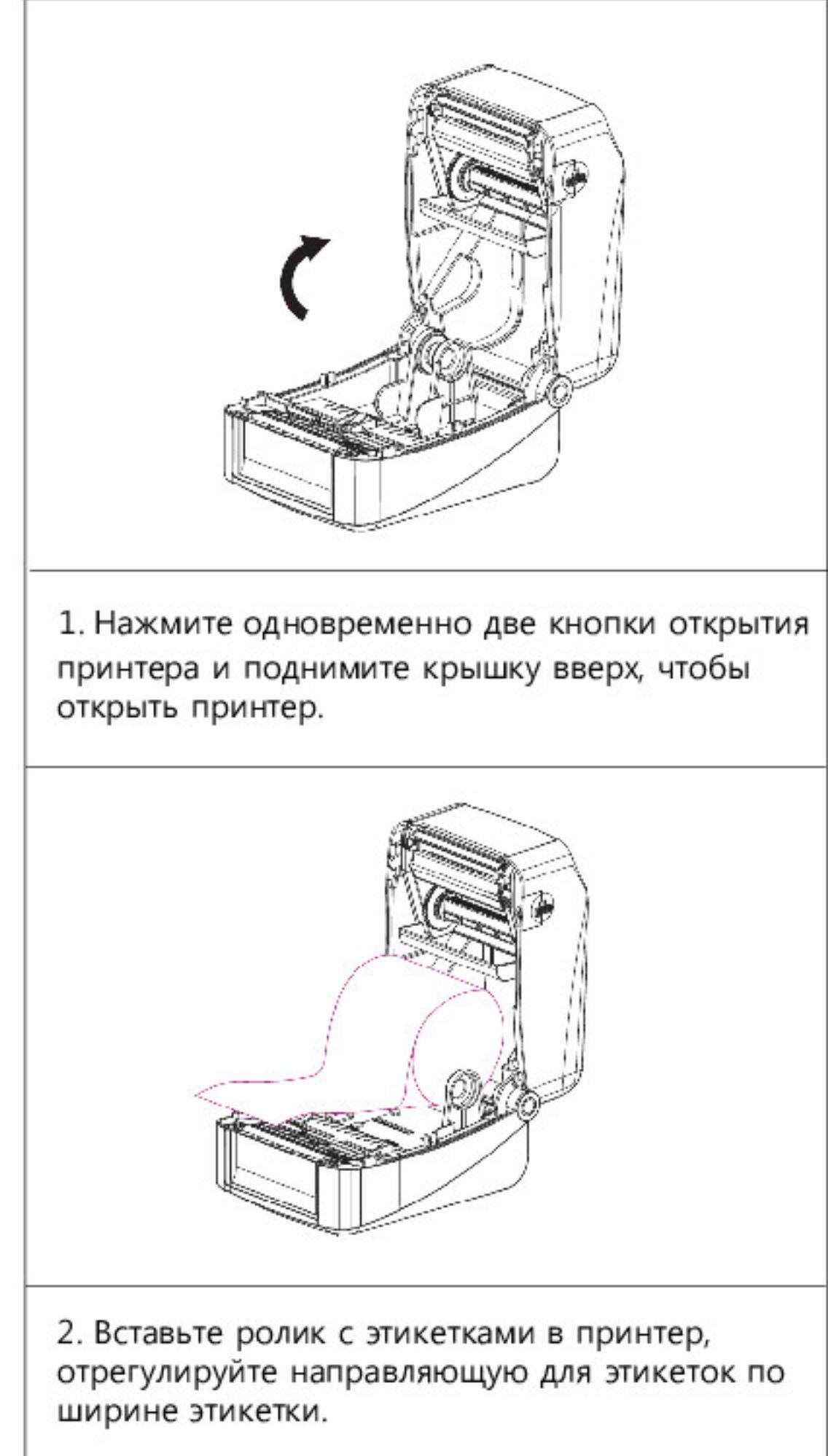
1. Нажмите одновременно две кнопки открытия принтера и поднимите крышку вверх, чтобы открыть принтер.
